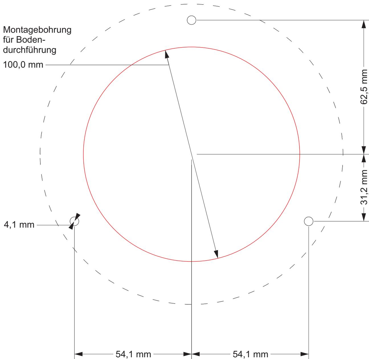
Zur Befestigung der Scheibe im Boden können Spax-Schrauben mit einem Durchmesser von 3,5 mm verwendet werden. Es empfiehlt sich hierbei die Schraubstellen mit einem Bohrer mit 2,5 mm Durchmesser vorzubohren.
