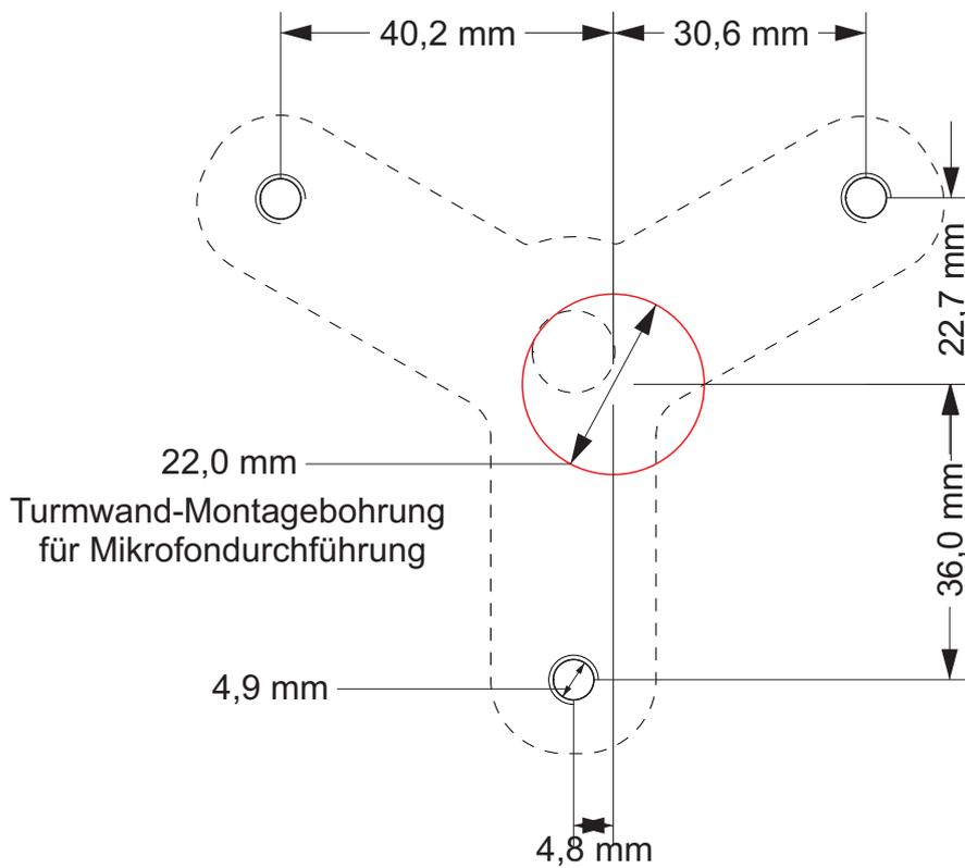
Dreibein nicht mittig über der Turmwand-Bohrung platzieren,
