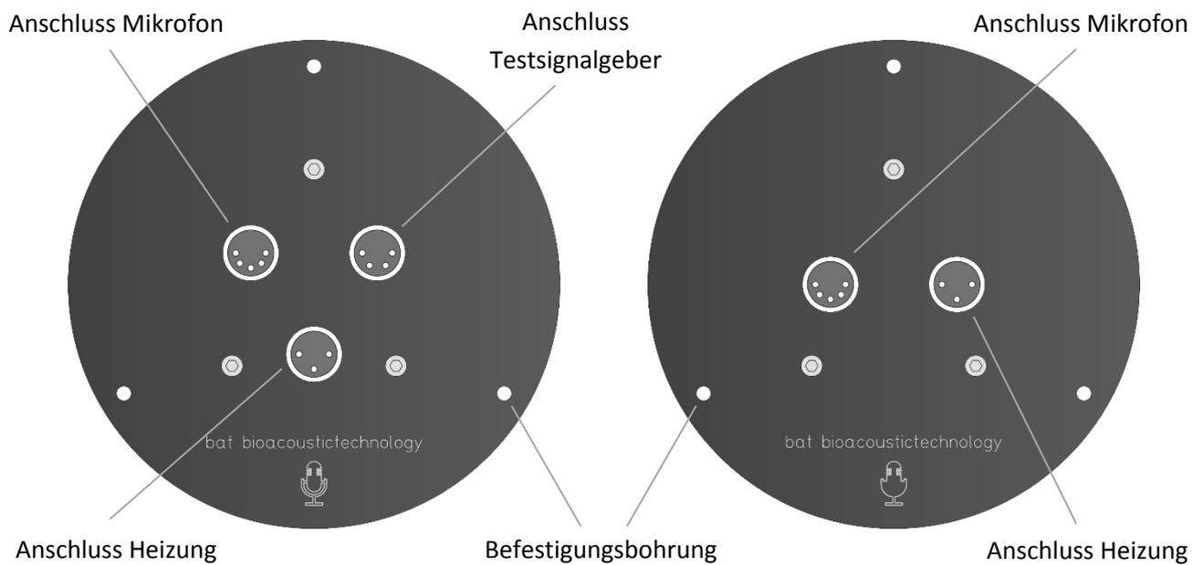
Abbildung 4: Alte und neue Version der Mikrofonscheibe
