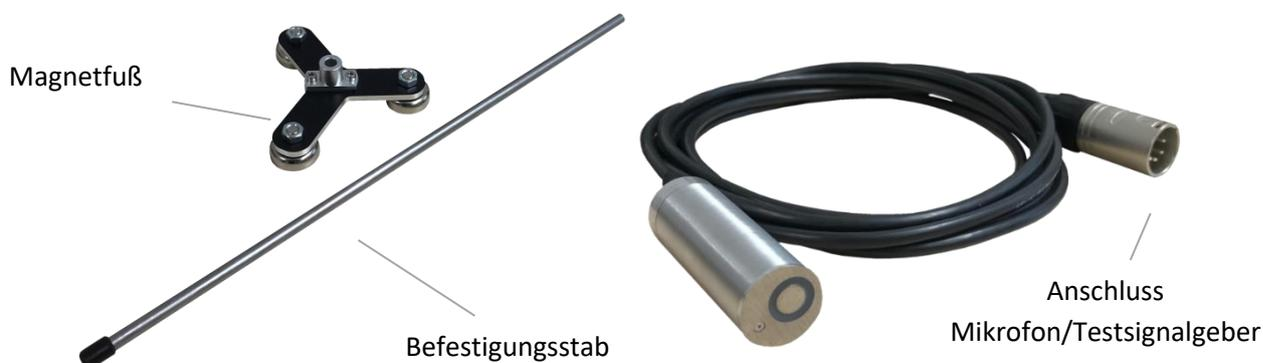
Abbildung 8: Turmmikrofon TM20 mit Befestigungsstab und Magnetfuß
